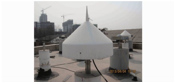
图 2 带天线罩的 S035 GPS 扼流圈天线 Fig. 2 S035 GPS choke-ring antenna with radome
