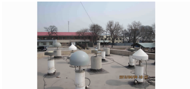
图 3 微边网观测墩上各种 GNSS 天线 Fig. 3 Different GNSS antennae in observation platform
