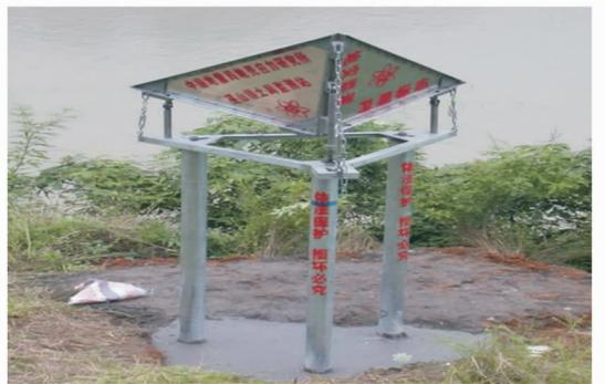
图4 遥感角反射器安装
